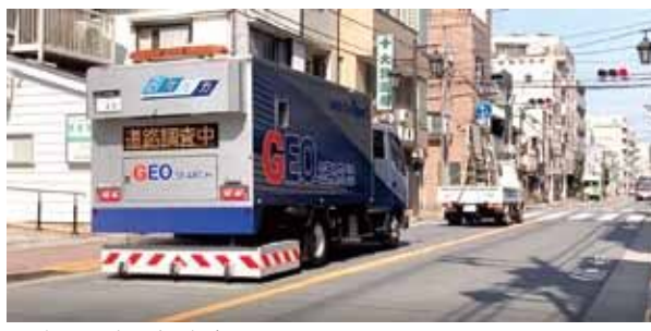
▲路面下空洞探査車 Dper
