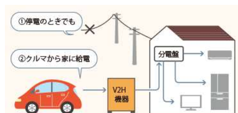
図 60 車から V2H を経由して家庭側に給電
