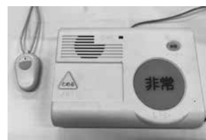
▲緊急通報装置
