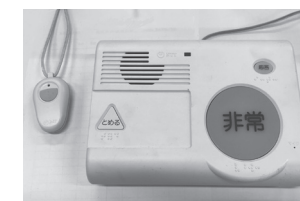
▲緊急通報装置
