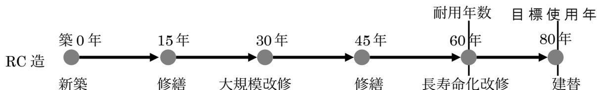
図 14 修繕・改修の周期(RC：鉄筋コンクリート造の場合)
